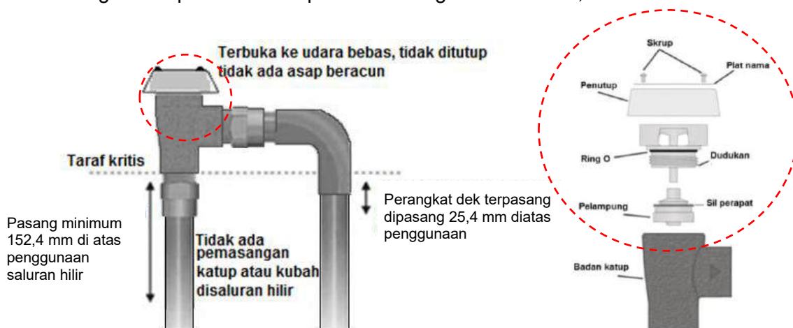
Gambar 31 – Pemasangan alat pemecah hampa
