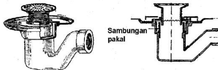
Gambar 56 – Lubang pembuangan shower
